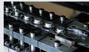
複雑形状を後加工なしに鍛造成形のみで仕上げるネットシェイプを追求します。
